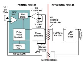
Fig. 3.4.1 Push Pull SMPS Block Diagram
