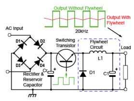
Fig. 3.1.1 The Buck Converter
